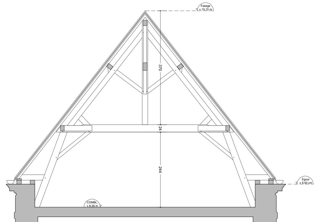
Ferme 1 à 6, charpente ancienne, assemblage par chevilles, tenons et mortaises
