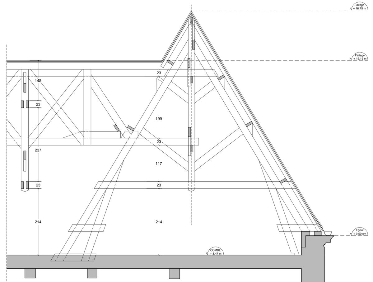
Ferme 12, charpente neuve, assemblage par tiges filetées et boulons
