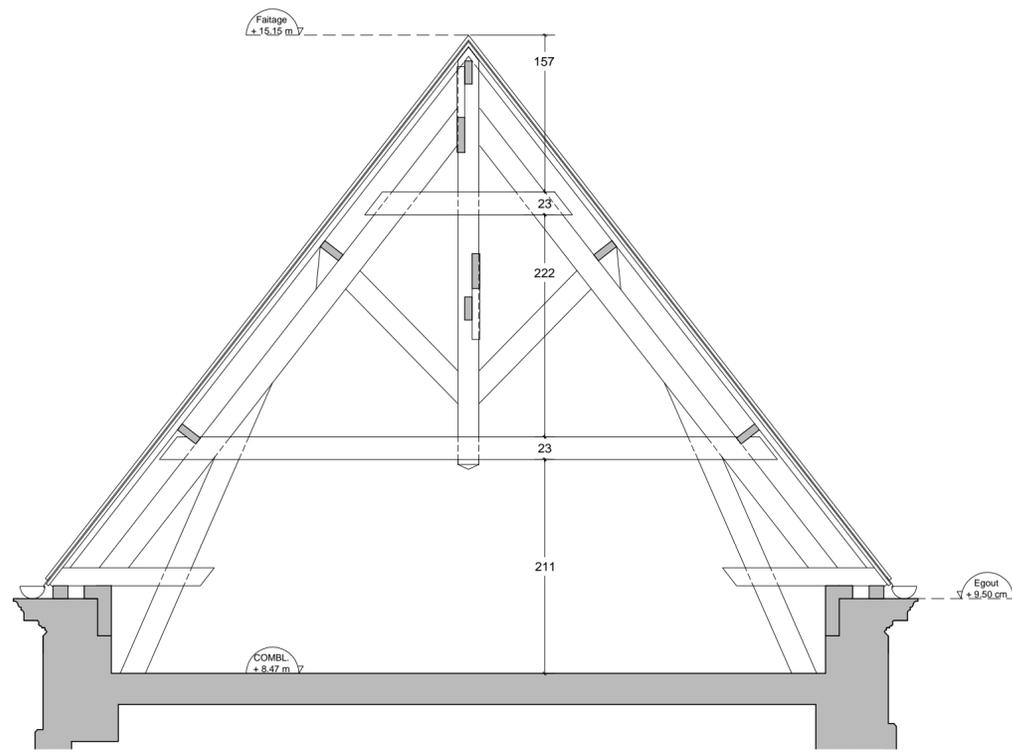
Ferme 7 à 11, charpente neuve, assemblage par tiges filetées et boulons
